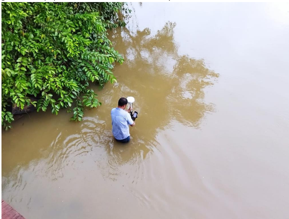
Figura 2: Equipamento Rover rastreando ponto cinemático no leito do rio.
